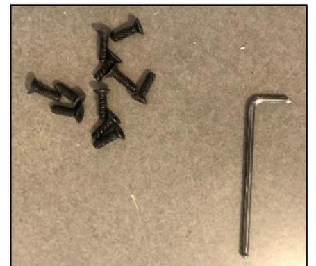
Visser les 2 limons entre eux à l'aide des vis 6x25 fournies et d'une clé Allen ou visseuse avec embout adapté
