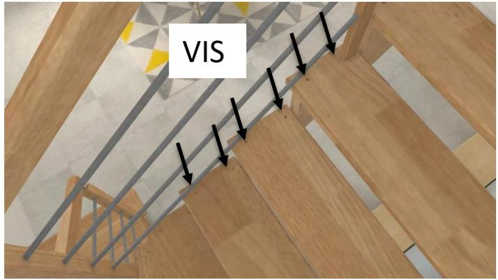
Mettre en place toutes les marches de l'escalier en insérant les marches dans l'entaille dans le limon au mur. De l'autre côté, vissez la marche par le dessus puis mettre des cache vis fourni. Utiliser les vis 5 x 70 fournies.
