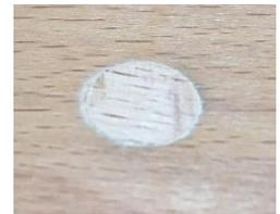
Mettre la carotte de bois dans le trou, enfoncer au marteau, scier le surplus à la scie oscillante, puis poncer pour la finition.
