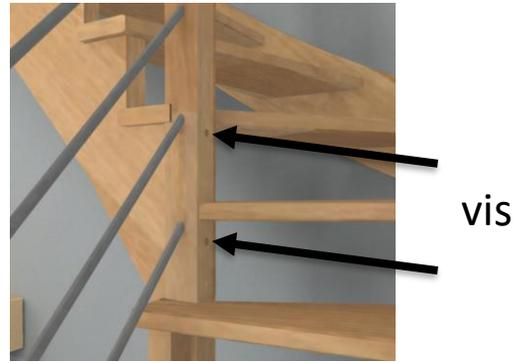
Au moment de mettre les marches d'angles et de départ, veiller à bien placer le poteau d'angle et le poteau de départ. Fixer les poteaux au limons au endroits des perçages prévus.
