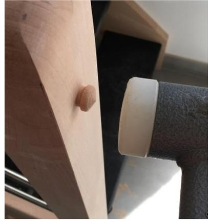
Comblent tous les trous de vissage avec les bouchons en bois. Enfoncez les bouchons avec un maillet.
