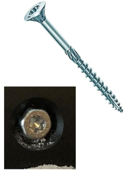
Fixer au mur les limons. Utiliser les vis adaptées selon le support. Ici on utilise de la vis 6x90 avec des chevilles nylon de  $\varnothing$  8. Si placo : utiliser des chevilles molly. Les têtes de vis ne doivent pas dépasser du limon.
