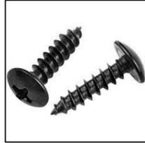
**Fixer le limon au sol** : percer le sol dans les trous de la platine du limon avec une mèche de  $\varnothing 8$ . Mettre des chevilles nylon de  $\varnothing 8$ . Visser avec les vis à penture 6x35 fournies. Renouveler l'étape pour tous les trous.
